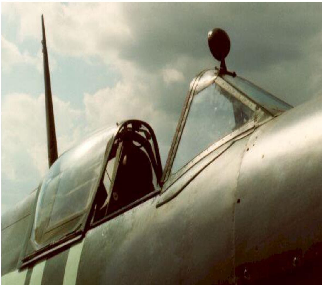
L'antenna VHF ( \frac{1}{4} Lambda) era posizionata verticalmente sulla superficie superiore della fusoliera.
