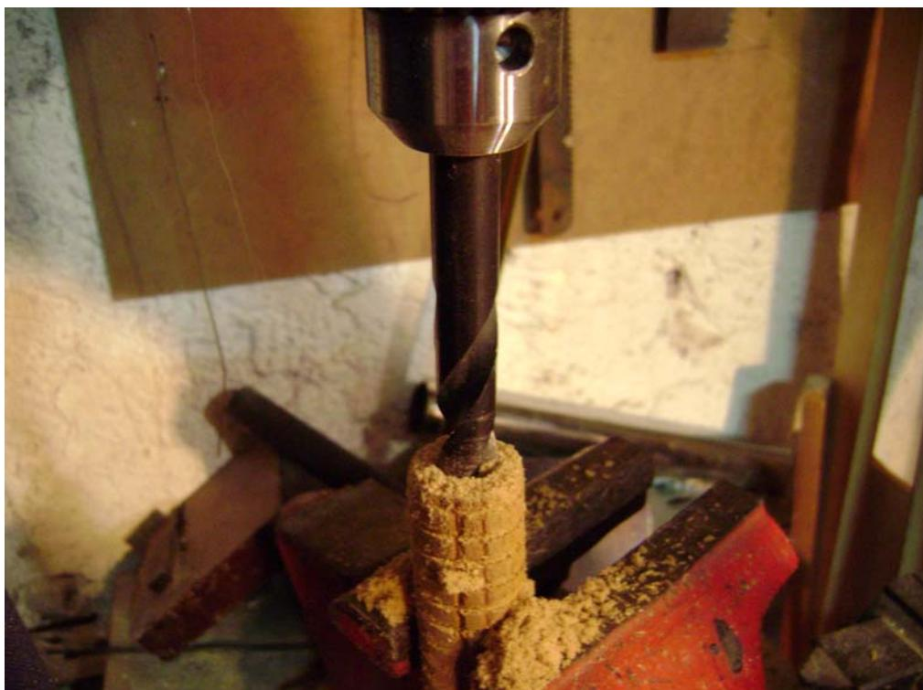
LAVORAZIONE DELLA BARRA PER L'INSTALLAZIONE DELL'INSERTO
