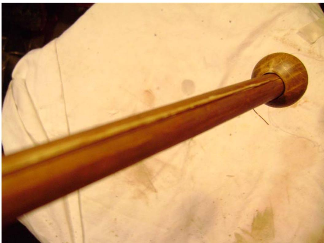
VISTA LONGITUDINALE DELLA BARRA SUPERIORE GIÀ SCANALATA SU CUI È STATO INSTALLATO IL FILO E LA SFERETTA TERMINALE.
