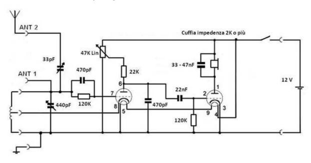
Ho scelto questa valvola perché è un doppio triodo di buone caratteristiche e di consumo molto ridotto, circa 160mA, ed anche perché è etichettata come valvola di bassa frequenza (la sfida era quella di usare una valvola non specifica per l'alta frequenza ma di uso comune).
