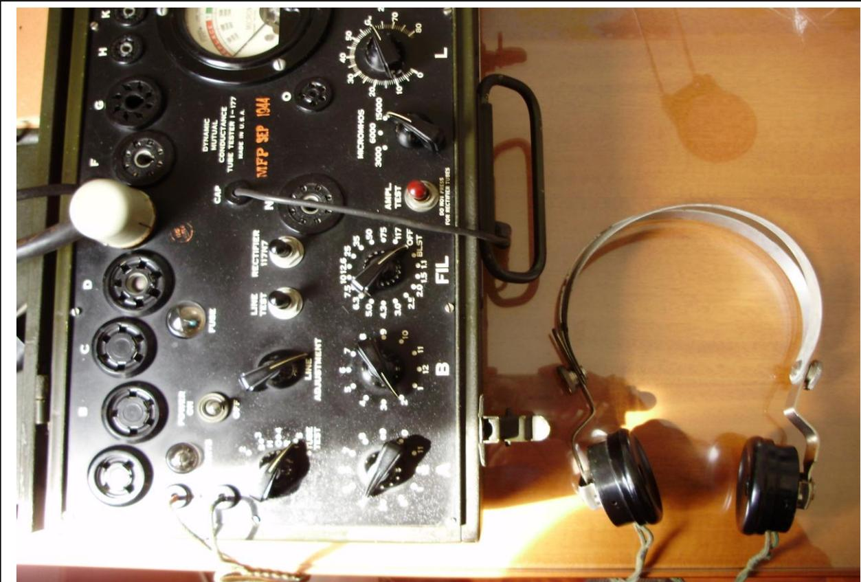
Figura 24 – Provavalvole I-177 (NOISE TEST)
