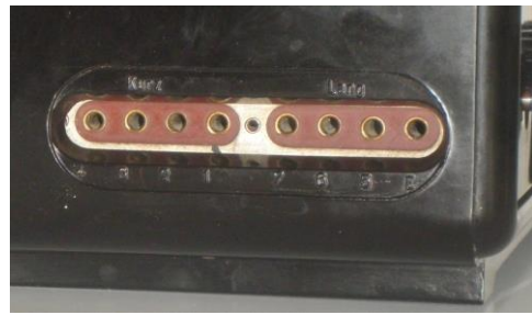
Preso Terra, antenna O.M e O.L.
